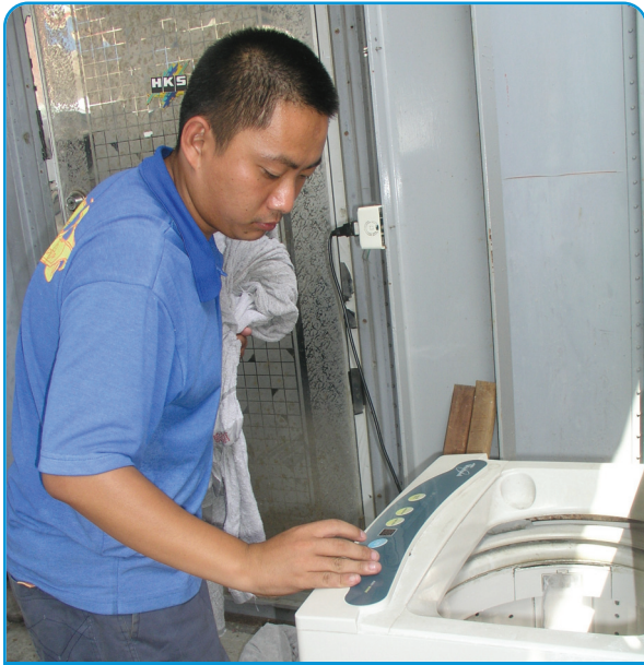
▲經過職務再設計所補助的全新脫水機，只要一打開蓋子，就會自動停止運轉。
